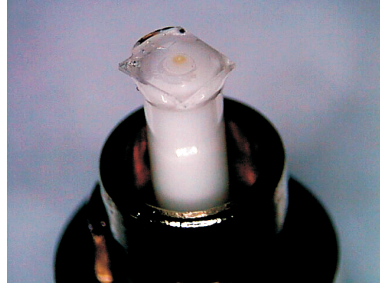
Figuur 6.4: FC/PC geconnectoriseerde SM vezel met microlens.
